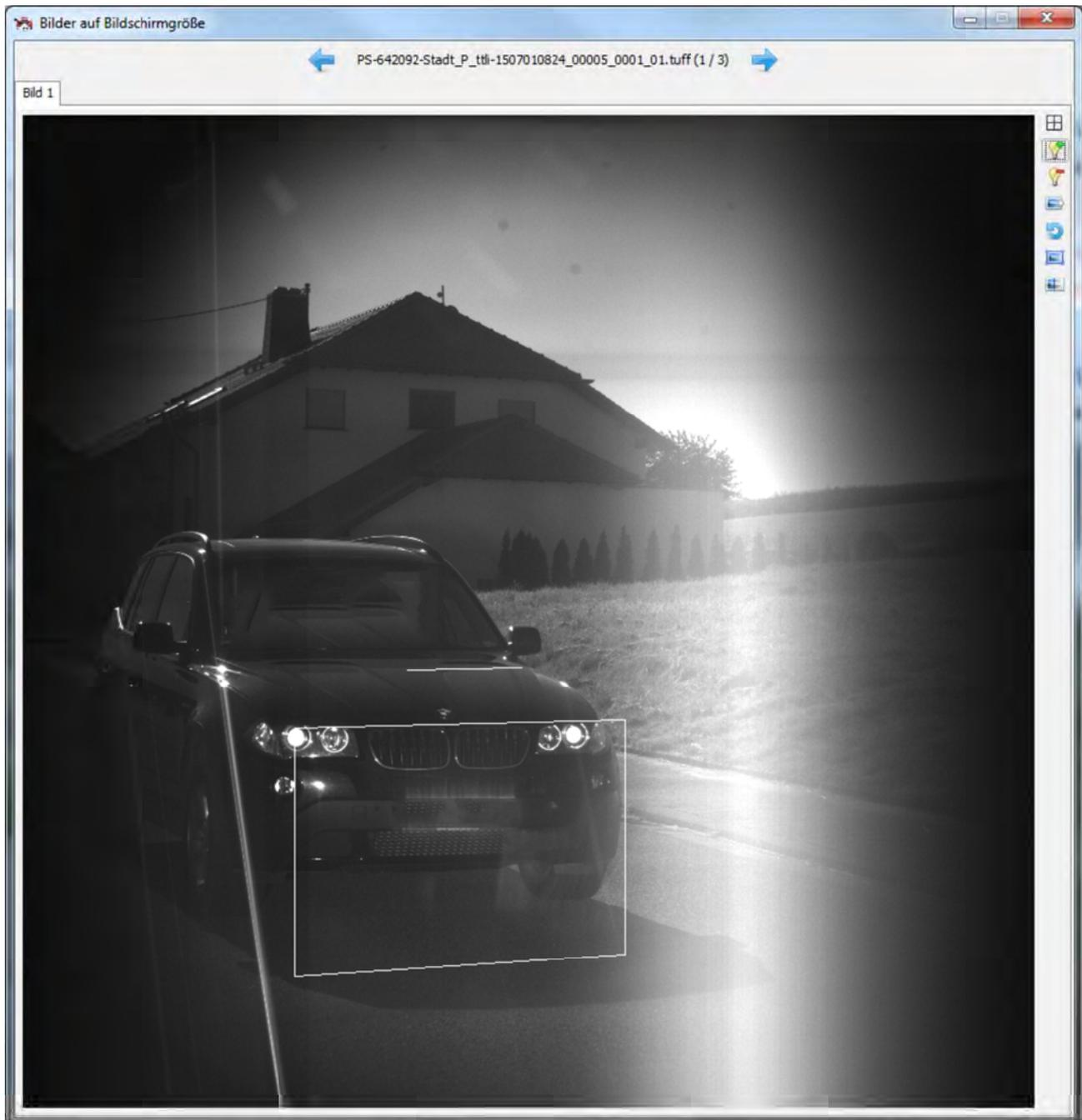
Abbildung 16: Ausschnitt aus einem aktuellen Messfoto (reguläre Aufstellhöhe von 1,3 m in der Bediensoftware angegeben)
