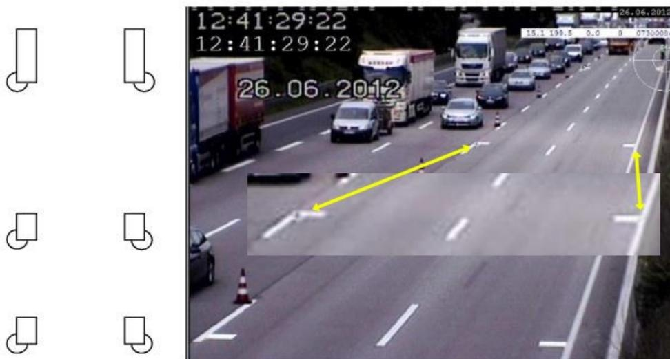
Abbildung 32: Veranschaulichung der üblichen Lage des definierten Eckpunkts; Auszug aus Blatt 66 der Gebrauchsanweisung [8] unter eigener Bearbeitung (Ausschnittsvergrößerung zur Verdeutlichung der Lage der Kontrollpunkte)
