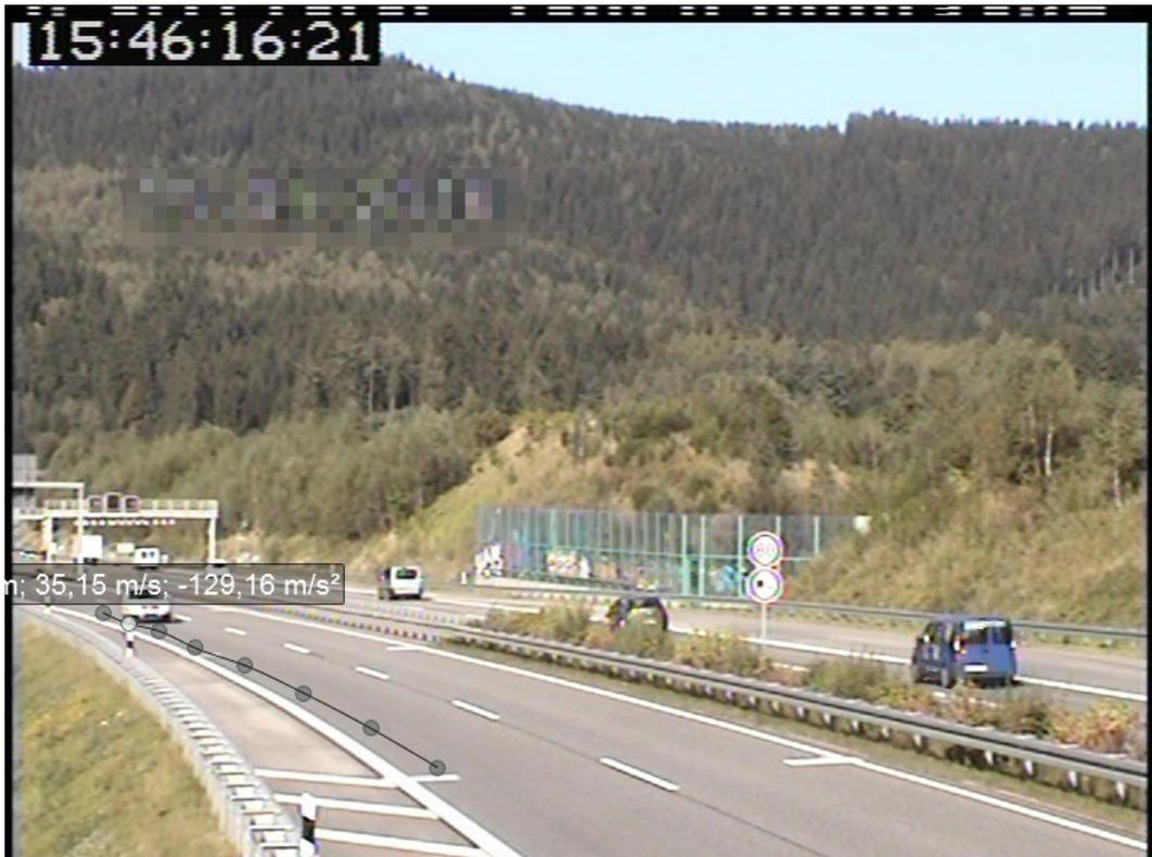
Abbildung 27: Markierung des selben Bezugspunktes zu einem acht Einzelbilder (0,32 s) späteren Zeitpunkt. Quelle: A17D07VA04KH
