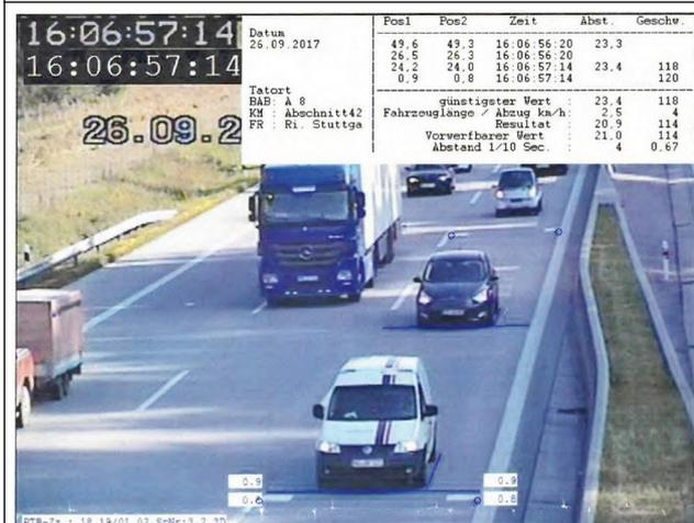
Abbildung 65: Auswertung einer Aufnahme aus 2017 in Darstellungsform 2; entnommen aus hiesigem Vorgang A18B01VA05
