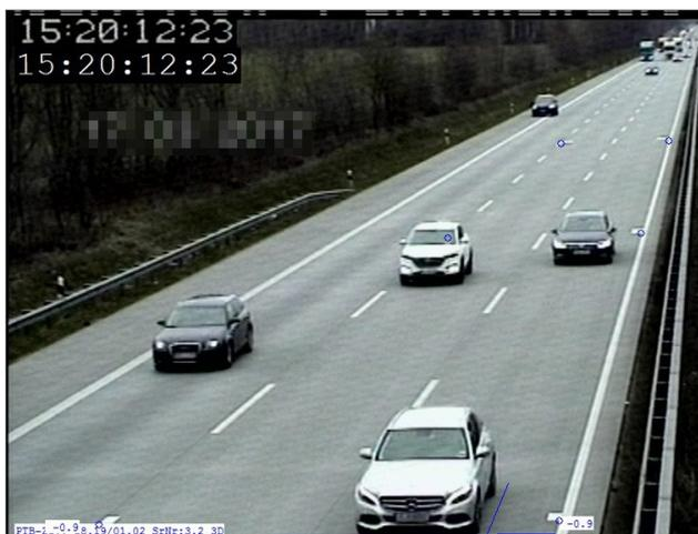
Abbildung 49: Screenshot der Auswertesoftware bei der bisherigen Auswertung; bei Laufzeit **12:23** steht der vorausfahrende Mercedes mit der Vorderachse **hinter** den Passpunkten P1/P4. Quelle: A17H22VA01KH
