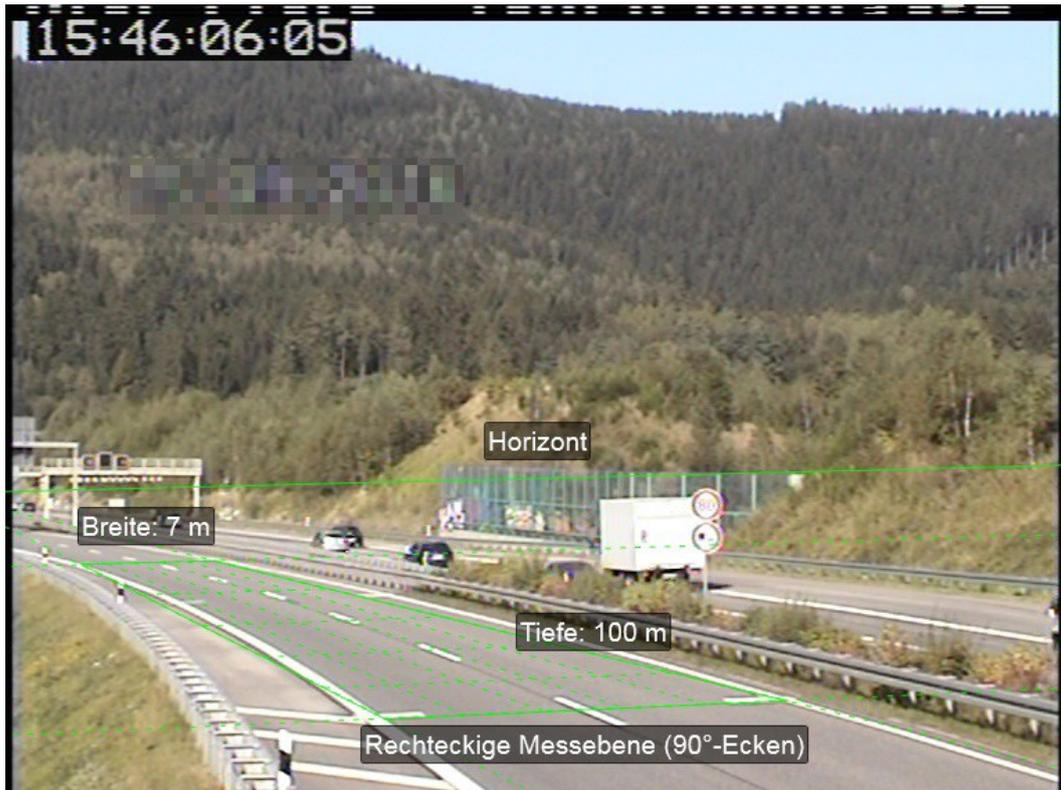
Abbildung 24: die Eckpunkte der aufgespannten Ebene entsprechen den Eckpunkten der behördlichen Markierung. Quelle: A17D07VA04KH
