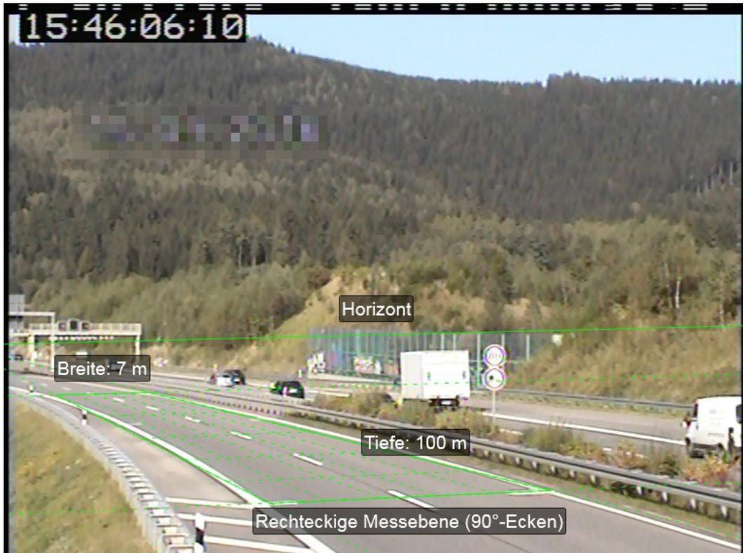
Abbildung 25: durch das Hüpfen der Aufnahme weicht die Lage der Ebene deutlich von den Bezugspunkten ab. Quelle: A17D07VA04KH
