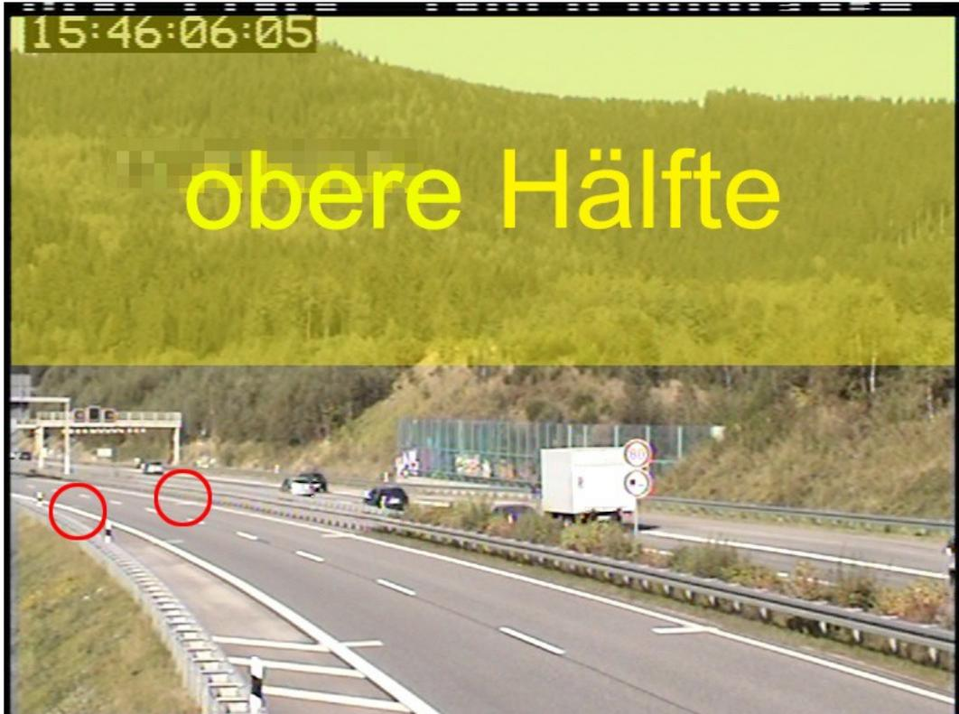
Abbildung 23: farbliche Hervorhebung der oberen Bildhälfte, in der sich laut Gebrauchsanweisung die hier rot eingekreisten Passpunkte P2 und P3 befinden müssen, um eine akzeptable Auswertetiefe zu erreichen. Quelle: A17D07VA04KH
