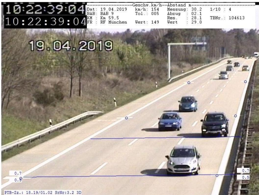
Abbildung 58: Ergebnis einer behördlichen Auswertung mit dem Datenbalken innerhalb des Fotos; der Datenbalken selbst enthält keine Positionsdaten der Fahrzeuge; entnommen aus hiesigem Vorgang A19G26VA02
