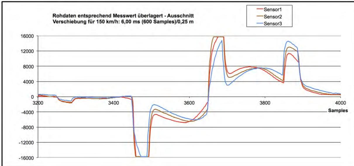
Bild-Nr. 9.: korrelierte Signalkurven S1 – S3 im Zeitfenster 32 – 40 Millisekunden
