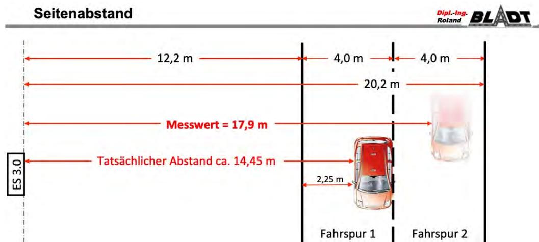
Bild-Nr. 22.: Maßstabgetreue Skizze der Messstelle – Draufsicht
