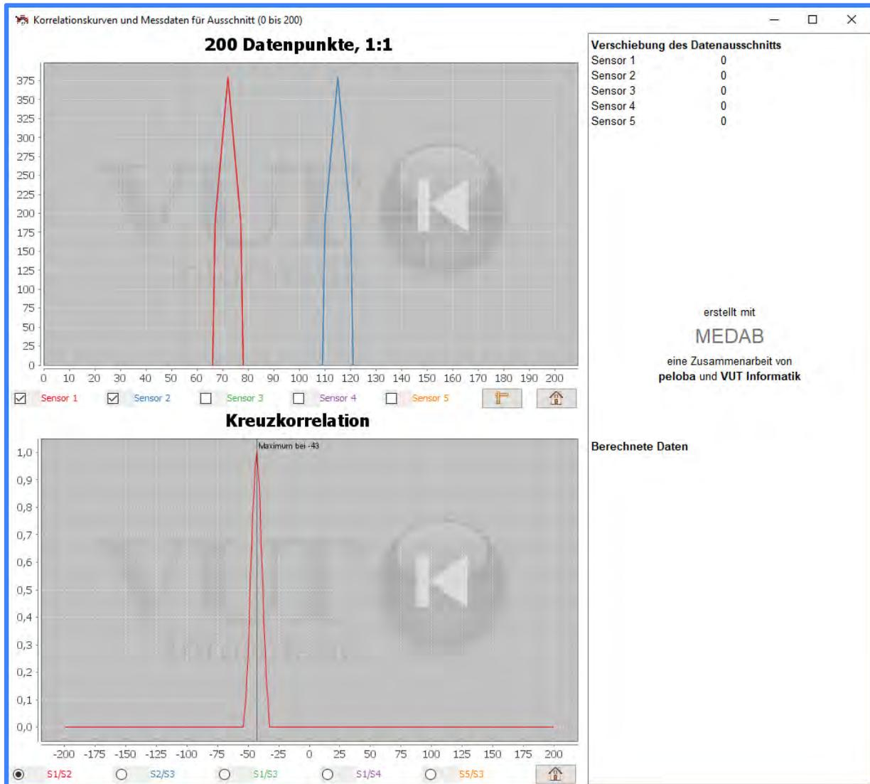
Bild-Nr. 34.: Einzelnes Dreiecksignal (z. B. Fahrzeugdurchfahrt)
