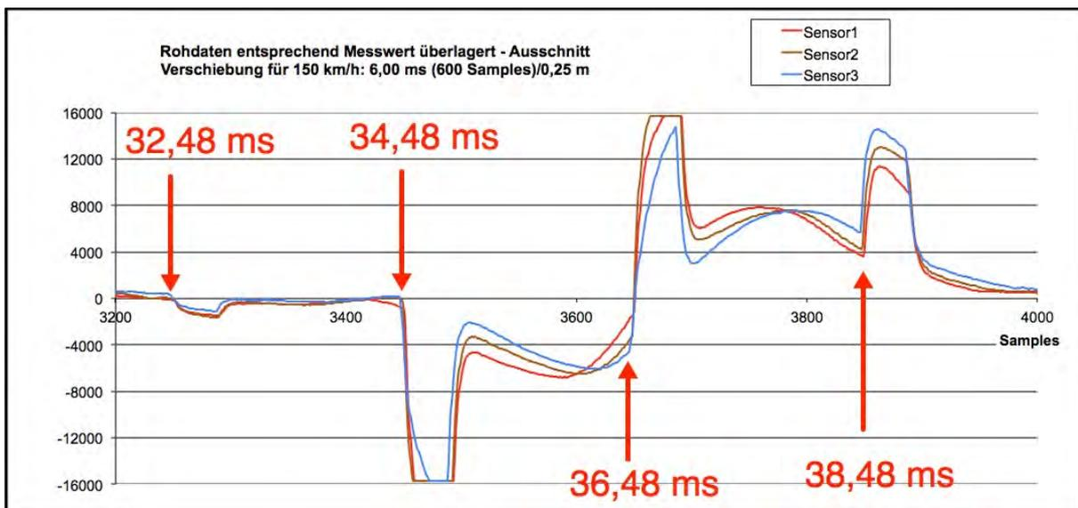
Bild-Nr. 10.: korrelierte Signalkurven S1 – S3 im Zeitfenster 32 – 40 Millisekunden
