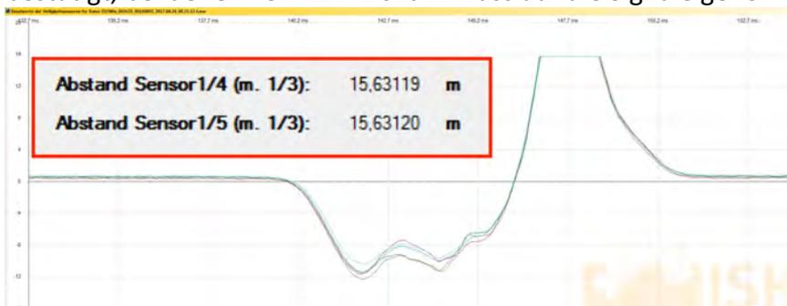
Bild-Nr. 19.: Korrelationsrechnungen zum Seitenabstand am Ende der Signalaufzeichnungen
