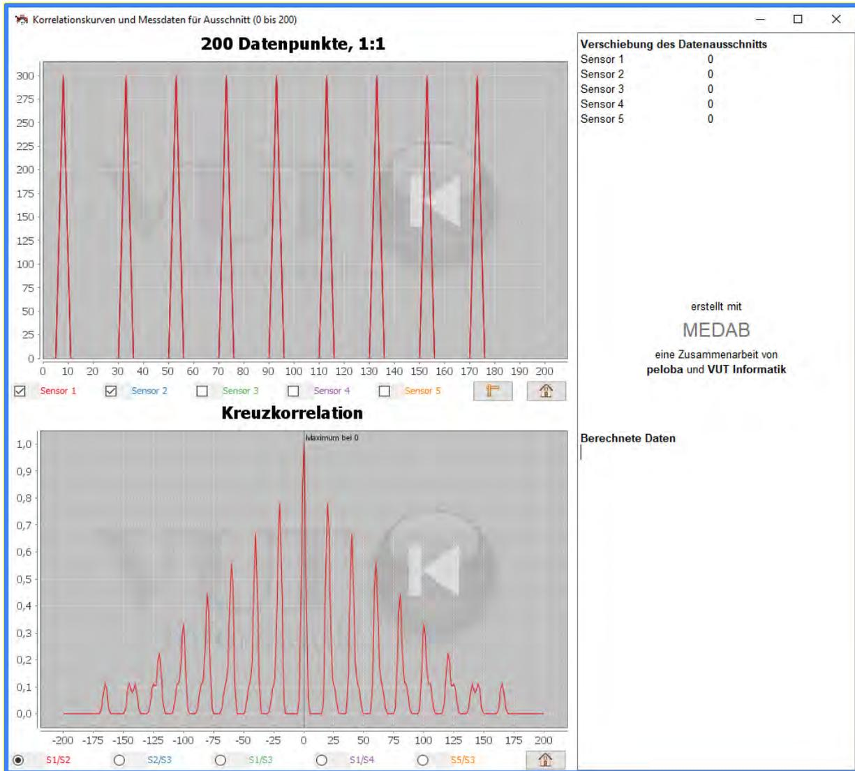
Bild-Nr. 33.: Periodisch auftretende Dreieckssignale (oben), Korrelationsfunktion (unten)
