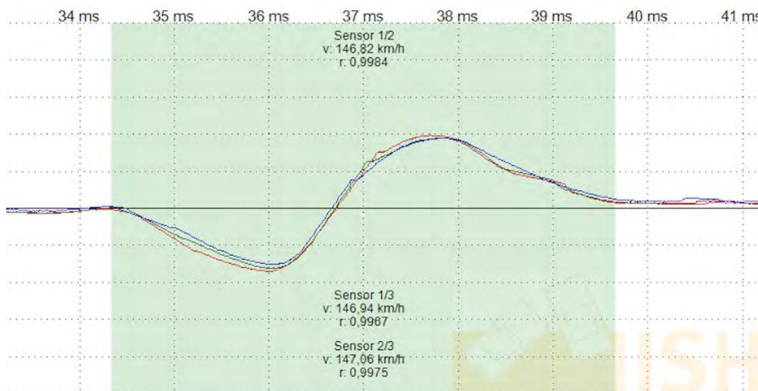
Bild-Nr. 12.: Korrelationswerte im Bereich 34,5 – 39,5 ms
