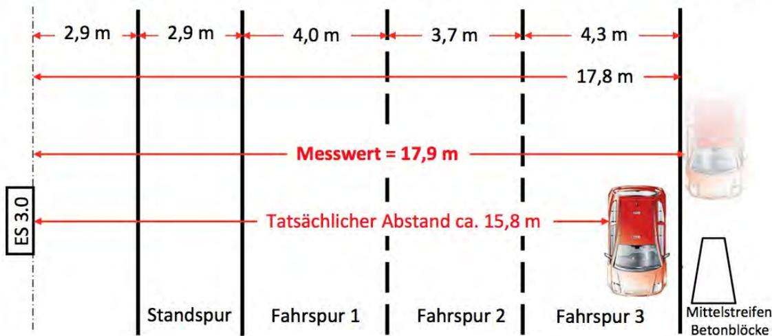
Bild-Nr. 7.: Maßstabgetreue Skizze der Draufsicht Messstelle
