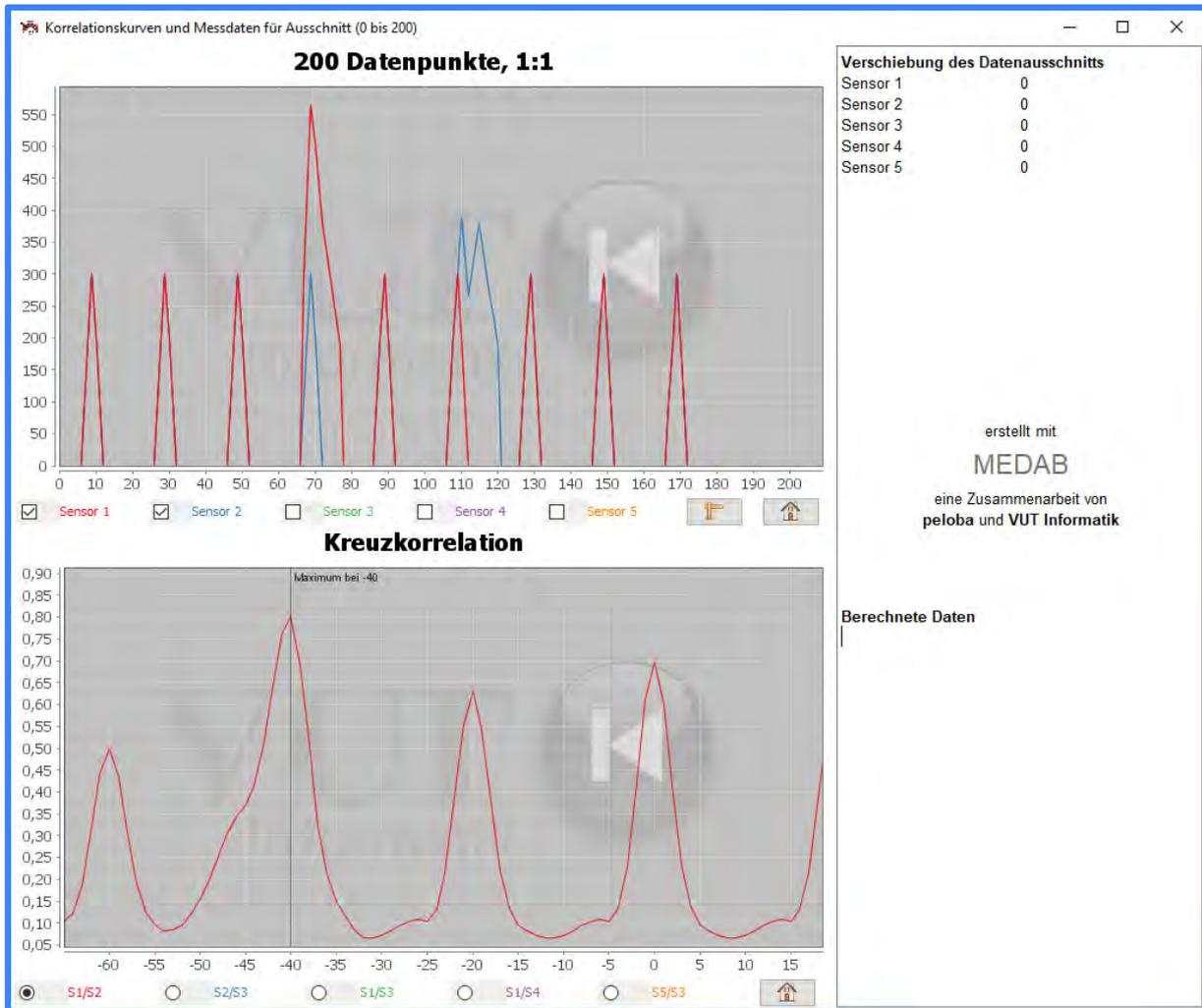
Bild-Nr. 35.: Überlagerung von Nutzsignal und Pulsen
